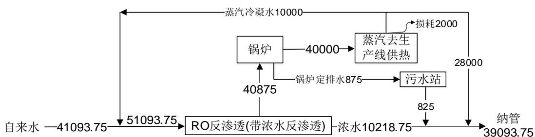
图 2-1 本项目水平衡图(单位：t/a)
