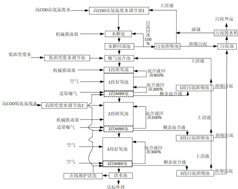
**图 4-3 企业废水处理工艺流程**
