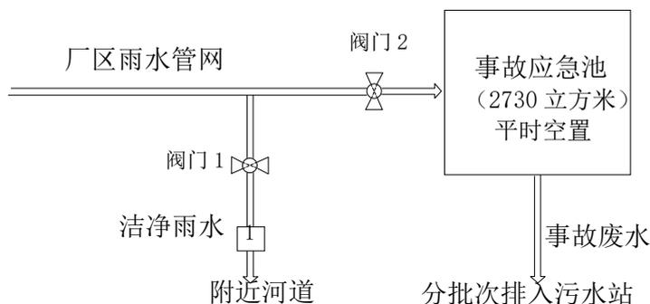
图 1-2 事故废水收集管理示意图
